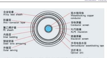
■ ZS-YJQ41 XLPE绝缘铅套粗钢丝铠装纤维外被层海底光电复合缆
